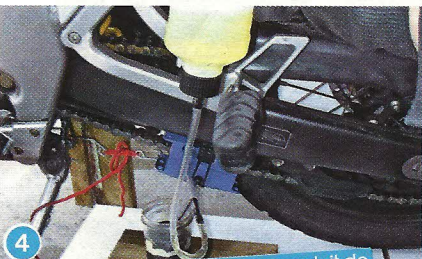
4 Une fois en place, on injecte le produit de nettoyage (kerdane ou pétrole désaromatisé, mais pas d'essence, de gas-oil ni de nettoyant frein) et on fait tourner la roue (soulevée !).
